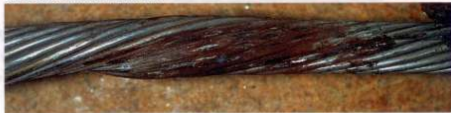
Figure 4 Usure et corrosion de friction sur un toron de nœud après env. 50.000 alternances de flexion.
